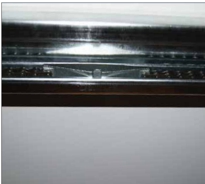
Finn skjøten på kjedet i trekkskinna.
