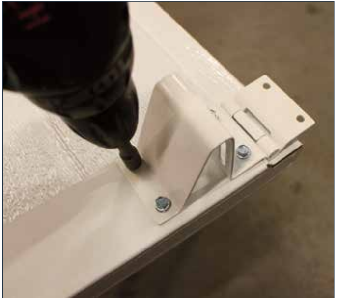
Monter sidehengsel som vist på bildet.
