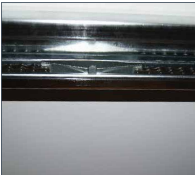
Finn skjøten på kjedet i trekkskinna.
